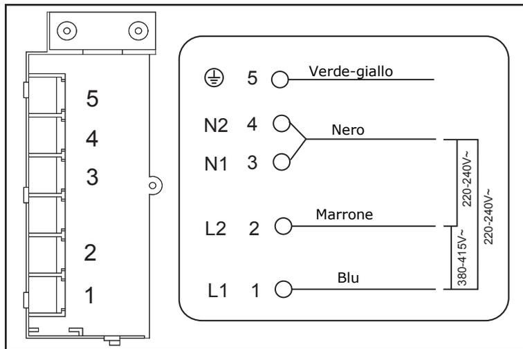
Se il numero totale di unità riscaldanti dell'apparecchio scelto non è inferiore a 4, l'apparecchio può essere collegato direttamente alla rete elettrica tramite un collegamento elettrico monofase, come mostrato di seguito.
